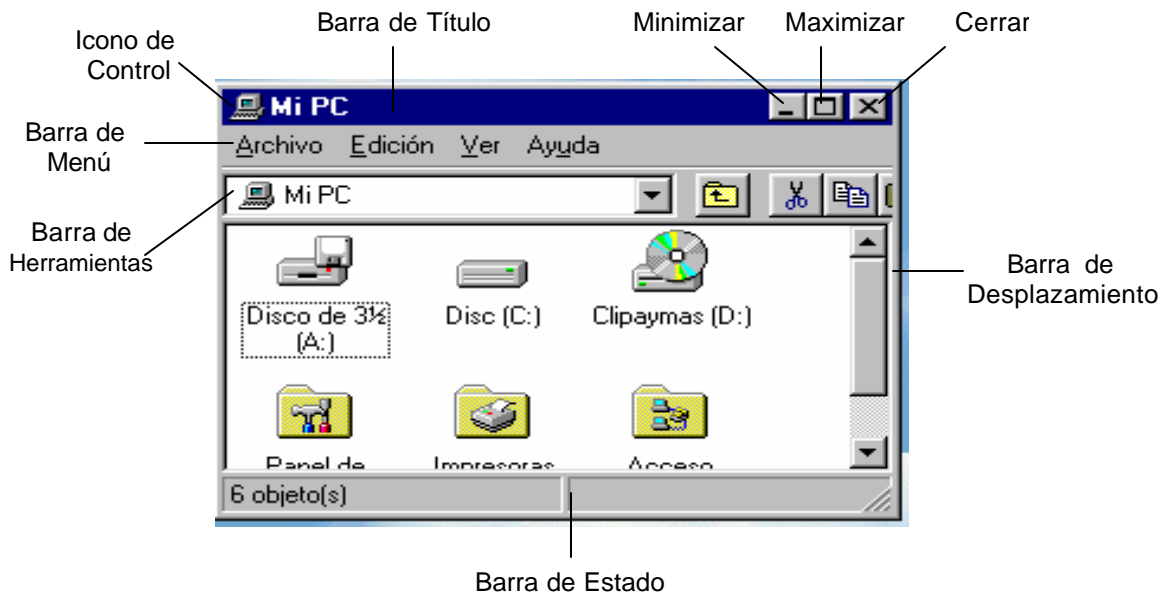
Fig. 2. Elementos de la Ventana.
